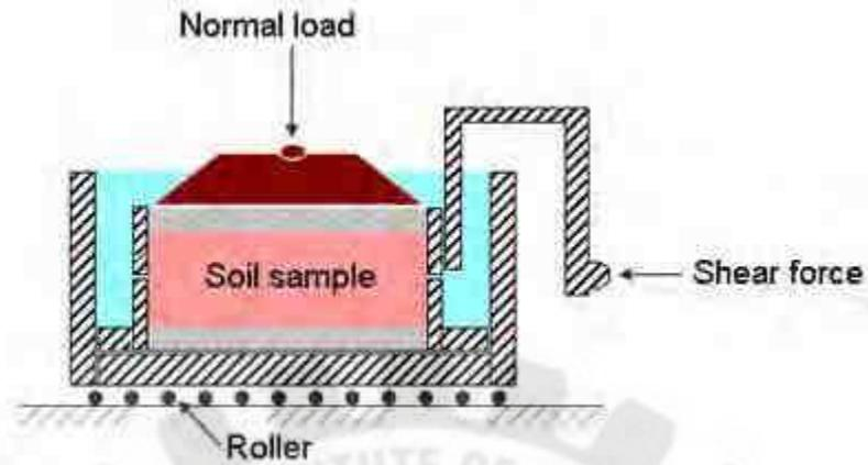
1.5.8. Direct Shear Apparatus
