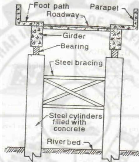
Fig. 5.22 Cylinder pier
