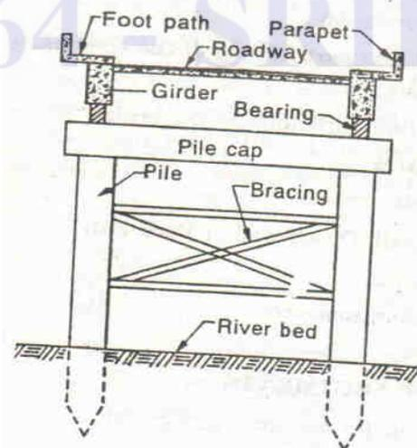
Fig. 5.23 Pile bent
