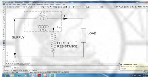
**Fig.3.3 a. Wattmeter connections**
