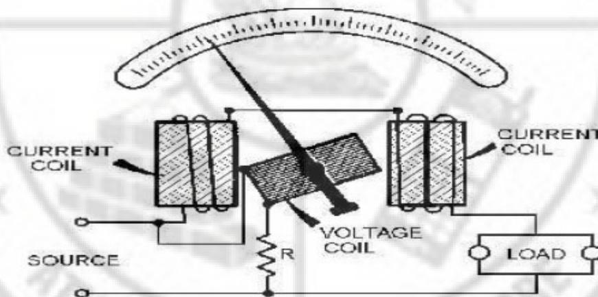
**Fig.3.2. Electro-dynamometer Wattmeter**
